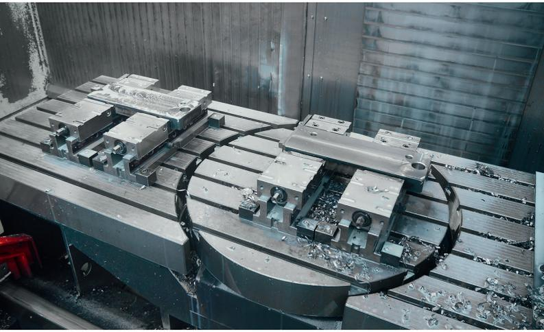
4 Mit Mehrfachaufspannungen, wie hier auf einer Tiltenta 7-3200, werden bei Claaßen Rüstzeiten und Rüstkosten reduziert © Hedelius
