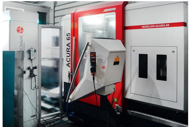
5 Zwei Acura 65 EL sind über eine lineare Erowa-Palettenautomation verkettet. Die seitliche Beladung ermöglicht weiterhin die Zugänglichkeit zum Arbeitsraum von vorne © Hedelius
